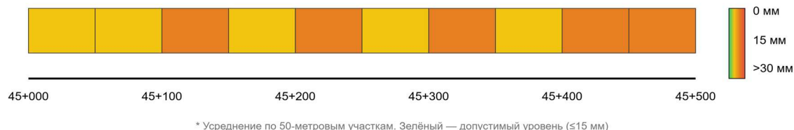
Рис. 2. Карта глубин колеи по участку (иллюстрация авторов)
