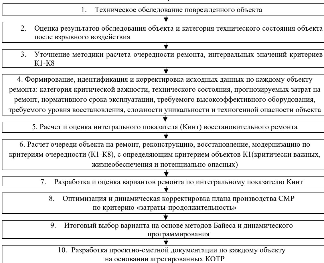
Рис. 4. Алгоритм принятия решения об очередности и видах работ на объектах (иллюстрация авторов)
