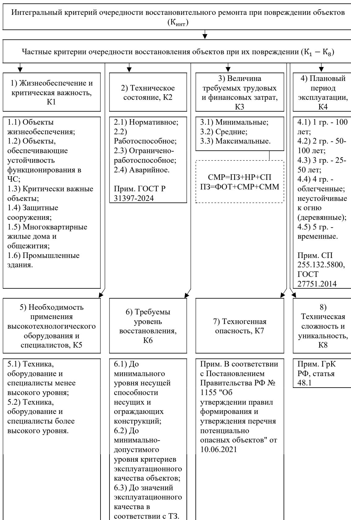
Рис. 3. Критерии очередности восстановления объектов при их повреждении (иллюстрация авторов)
