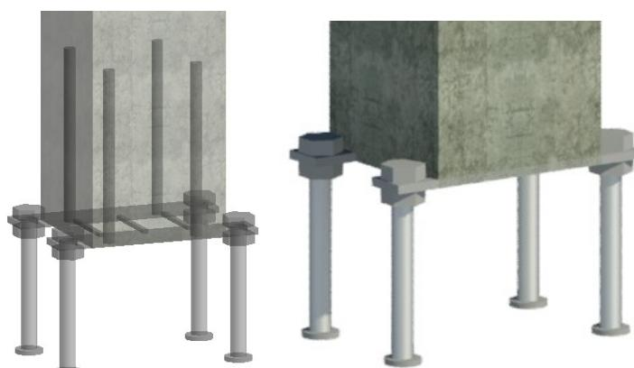
Рис. 3. Узловое соединение сборных железобетонных колонн с фундаментами с применением закладной детали (иллюстрация авторов)
