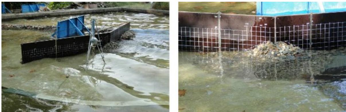
Рис. 10. Серия 3. Сооружение с волногасящим откосом в средней части. Вид модели во время (слева) и по окончании (справа) опытов (иллюстрация авторов)
