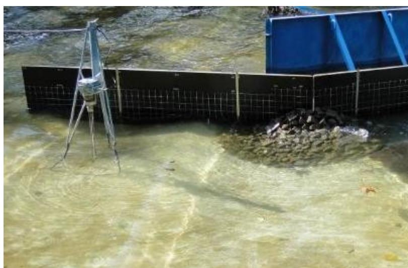
Рис. 12. Серия 4. Сооружение с волногасящим откосом в средней части.
