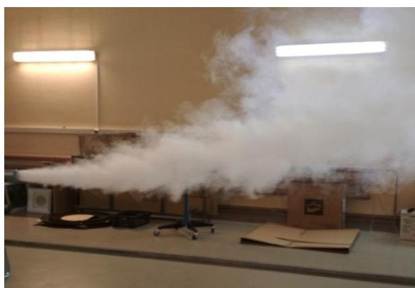
Рис. 1. Демонстрация развития приточной нагретой струи (иллюстрация авторов)
