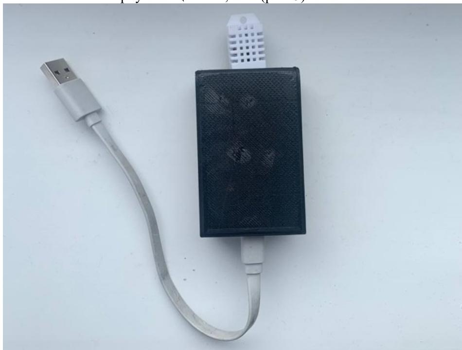
Рис.5. Измеритель температуры и влажности в корпусе (иллюстрация авторов)
