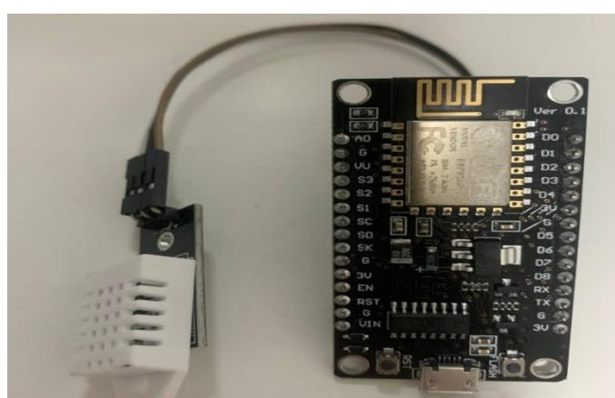
Рис.3. Прототип измерителя температуры и влажности (иллюстрация авторов)
