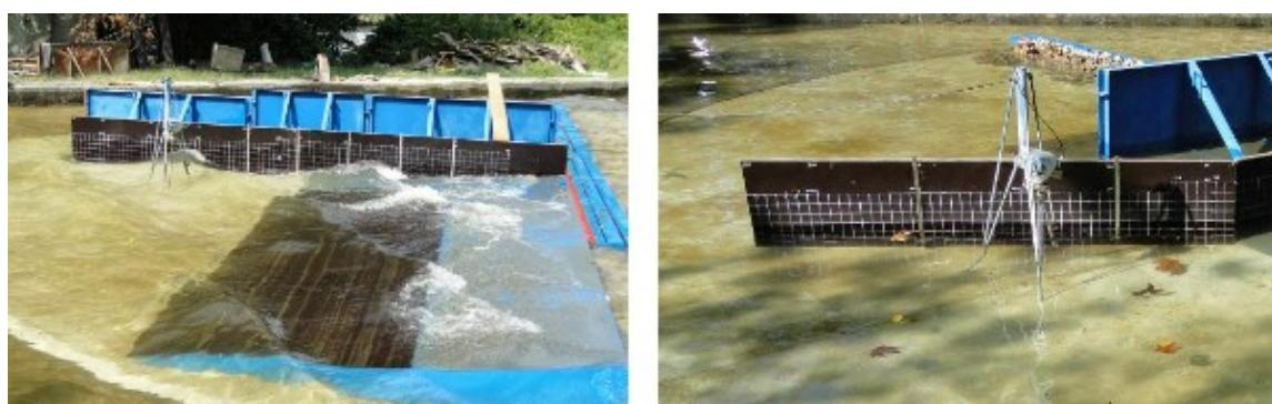
Рис. 4. Серия 1. Сооружение без волногасящего откоса. Вид моделей во время опытов (иллюстрация авторов)
