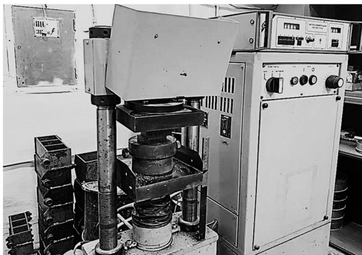
Рис. 3. Испытание бетонного образца на сжатие на испытательной машине СИ-2-100-УХЛ4.2 (иллюстрация авторов)
