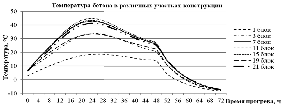
Рис. 3. График температуры бетона в разных блоках обработки (иллюстрация авторов)
