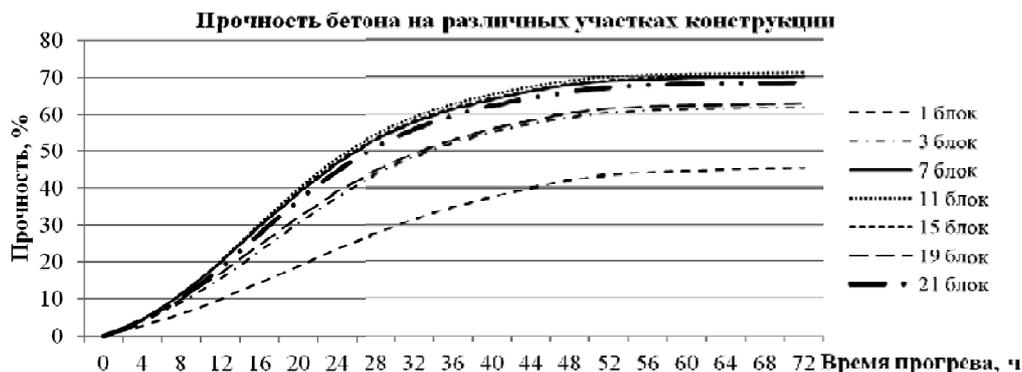
Рис. 4. График набора прочности бетона обработки (иллюстрация авторов)
