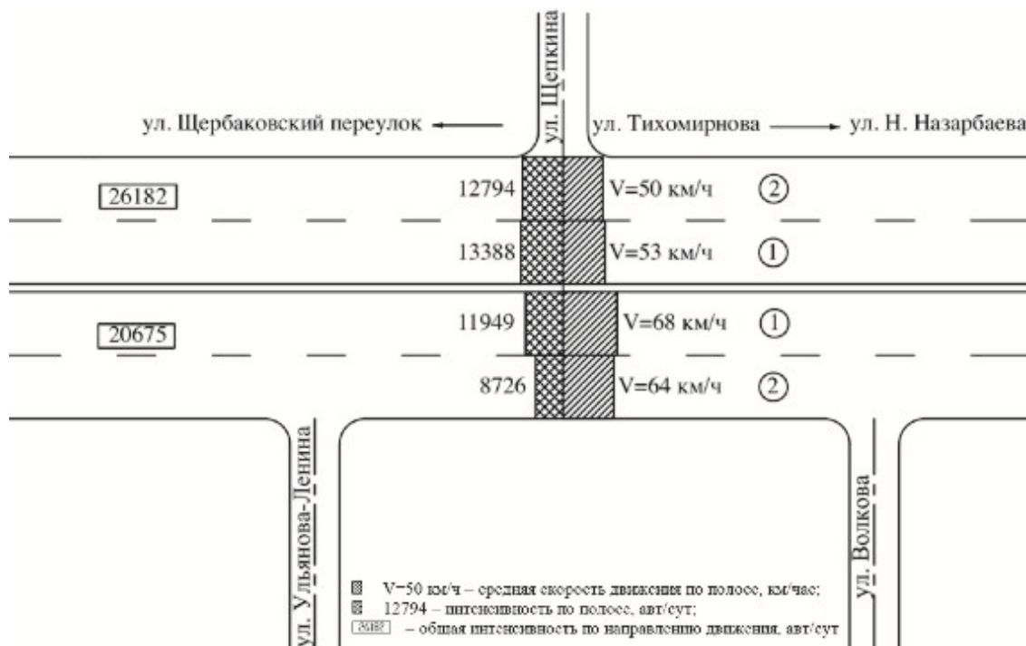
Рис. 1. График распределения скорости и суточной интенсивности движения на участке ул. Тихомирнова по данным автоматического учета
