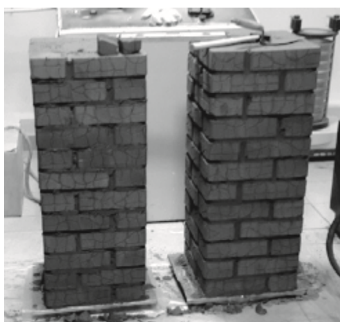
Рис. 1. Образцы каменной кладки без армирования
