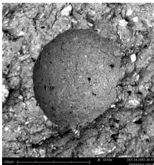
Рис. 4. Микроструктура образца на основе ЦНВ-50 в 1050-кратном увеличении
