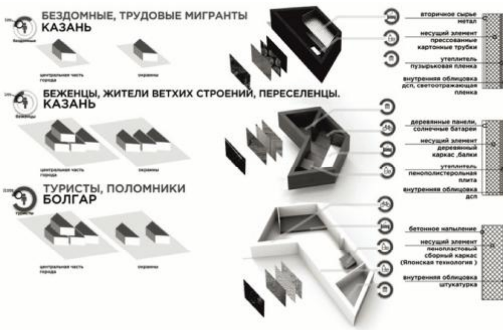
Рис. 3. Типология временных универсальных блок-модулей с учетом материалов и места возведения
