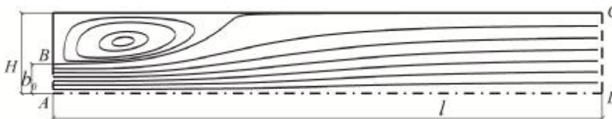
Рис. 2. Схема струйного течения в проточном канале: отрезок АВ – подача струи в тупик; CD – отрезок, где воздух вытекает из тупика
