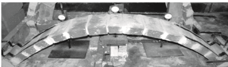
Рис. 4. Усиление верхней поверхности арок УГВ-лентами
