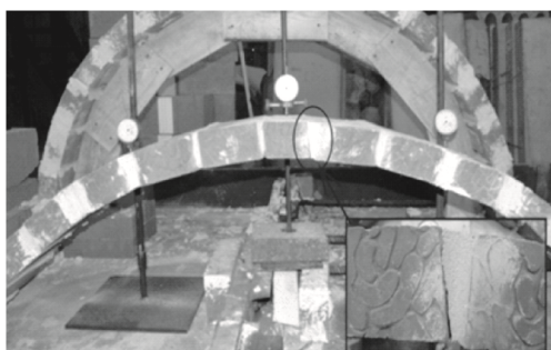
Рис. 3. Образование трещины в области щельги арки при горизонтальной подвижке опоры до 10 мм
