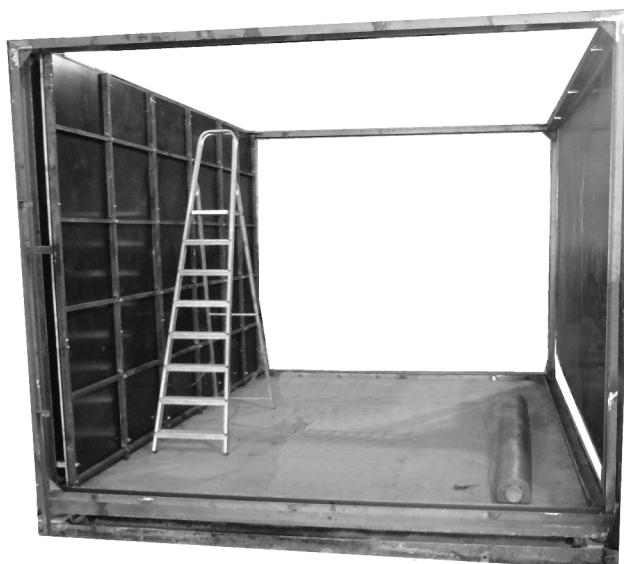
Рис. 3. Элементы сборно-щитовой опалубки
