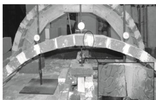
Рис. 3. Образование трещины в области щелыги арки при горизонтальной подвижке опоры до 10 мм
