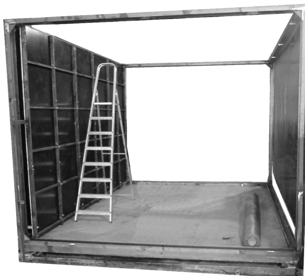
Рис. 3. Элементы сборно-щитовой опалубки
