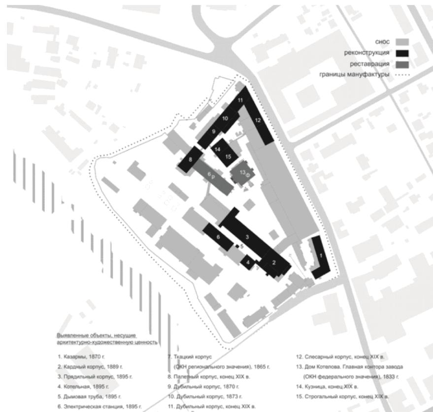
Рис. 3. Режимы реконструкций
