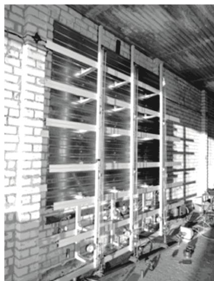
Рис. 1. Блочно-тросовая система нагружения фрагмента
