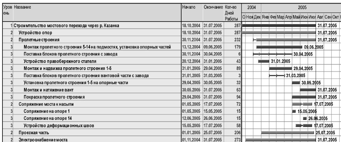
Рис. 1. Укрупненный календарный график строительства мостового перехода через р. Казанка
