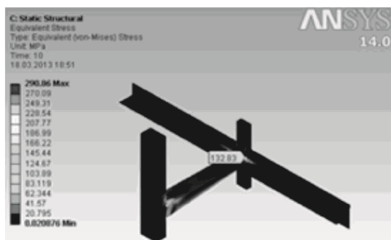
Рис. 6. Эквивалентные напряжения в элементах наружного контура системы при проектном варианте конструкции
