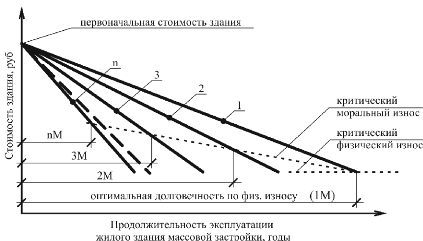
Рис. 4. Совместный физический и моральный износ: 1M – оптимальная долговечность по физическому износу; 2M, 3M, ..., nM – оптимальная долговечность по фактору морального износа
