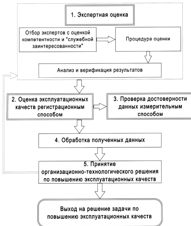
Рис. 3. Модель оценки эксплуатационных качеств монолитных конструкций при возведении зданий
