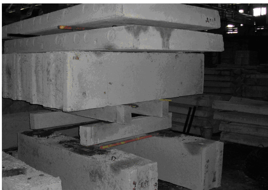
Рис. 4. Испытание железобетонных перемычек марки ЗПБ 16-37 разрушающей нагрузкой
