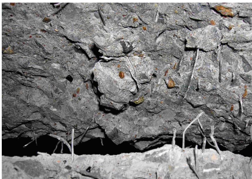
Рис. 6. Образец разрушенного сечения сталефибробетонной перемычки
