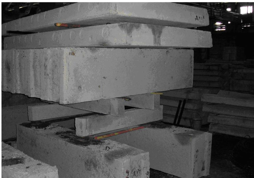
Рис. 4. Испытание железобетонных перемычек марки ЗПБ 16-37 разрушающей нагрузкой
