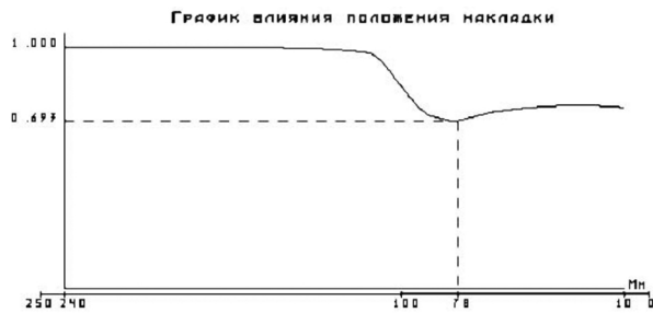
Рис. 3. Наклейки расположены на крайних трещинах
