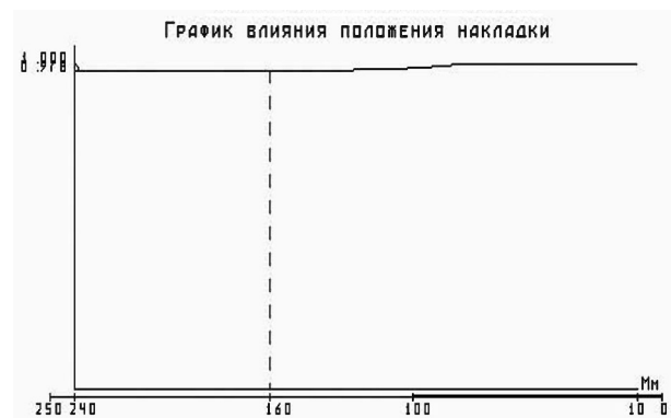
Рис. 1. Накладки расположены на средней трещине
