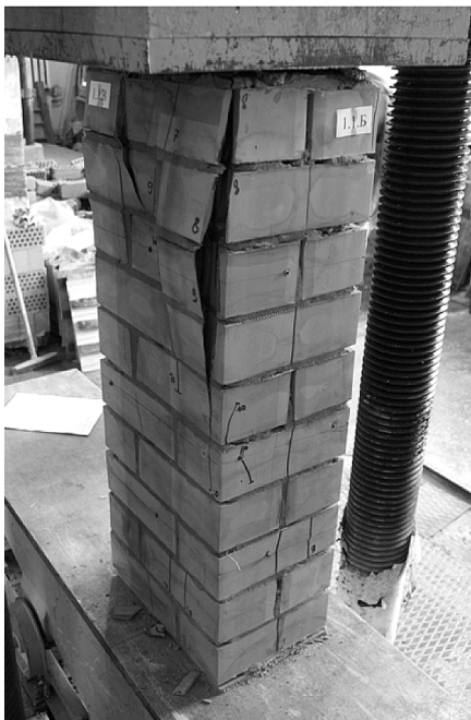
Рис. 3. Характер повреждения кладки опытных образцов – отслаивание наружных стенок нескольких рядов кладки (а), равномерное распределение вертикальных трещин в материале (б)
