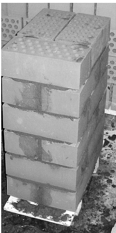
Рис. 2. Опытные образцы серий 1 (а) на стадии изготовления и подготовленные к испытаниям (б)
