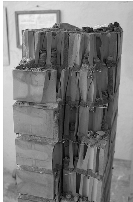
Рис. 3. Характер повреждения кладки опытных образцов – отслаивание наружных стенок нескольких рядов кладки (а), равномерное распределение вертикальных трещин в материале (б)
