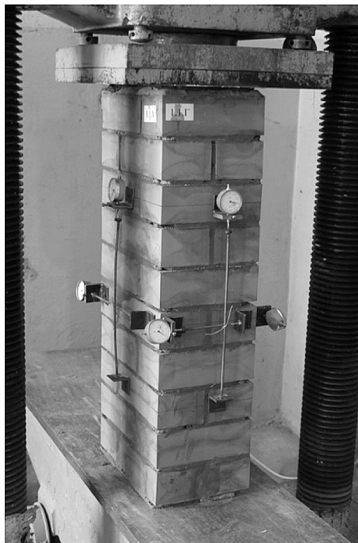
Рис. 2. Опытные образцы серий 1 (а) на стадии изготовления и подготовленные к испытаниям (б)
