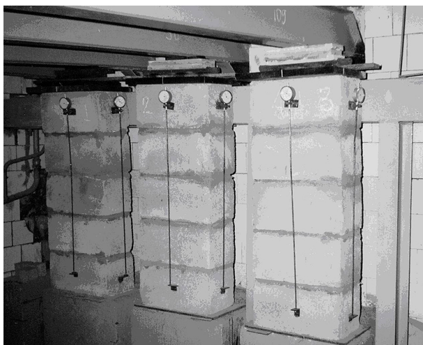
Рис. 1. Длительные испытания опытных образцов на одноосное сжатие
