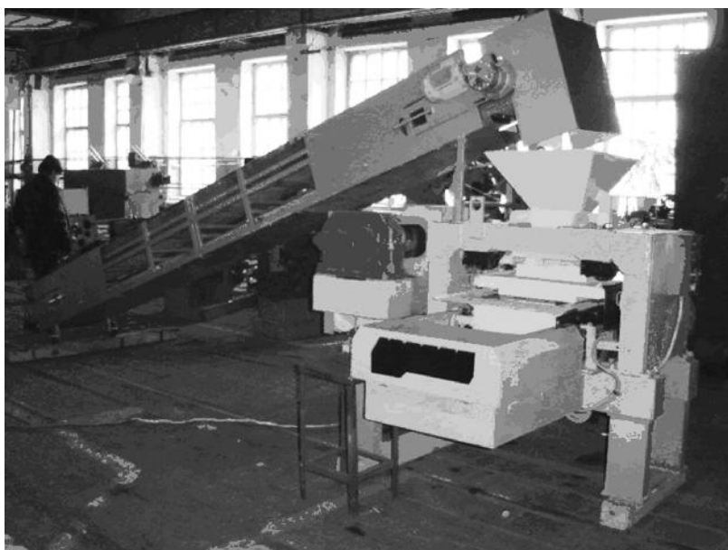
Рис. 10. Мобильная установка РК-250 для полусухого прессования стеновых изделий из различных материалов (грунтоблок, гипсоблок). Кувандыкский механический завод, Оренбургская область
