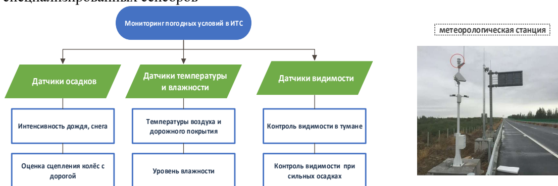
Рис. 3. Структура системы мониторинга погодных условий в интеллектуальных транспортных системах (иллюстрация авторов)
