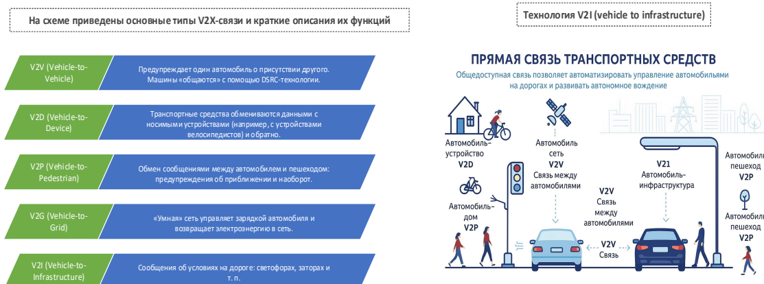
Рис. 2. Основные типы V2X-связи и прямая связь транспортных средств (иллюстрация авторов) Fig. 2. Main types of V2X communication and direct vehicle-to-vehicle communication (illustration by the authors)
