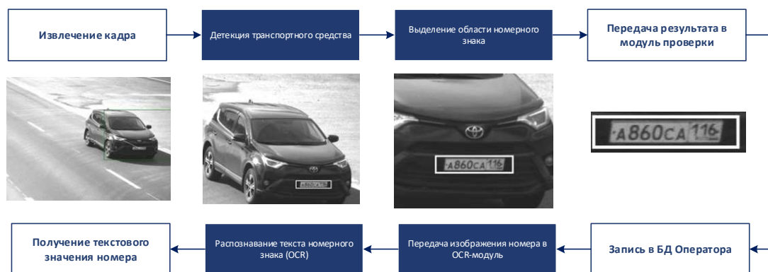
Рис. 9. Схема распознавания и чтения номерного знака транспортного средства
