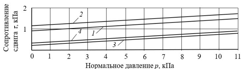
Рис. 3. Графики \tau = f(p) океанического ила при скорости среза V = 0,024 м/с и времени тиксотропного упрочнения t_{упр} = 1 и 6 сут: 1, 2 – пикового ( \tau_{max} ); 3, 4 – остаточного ( \tau_{res} ) (иллюстрация автора)
