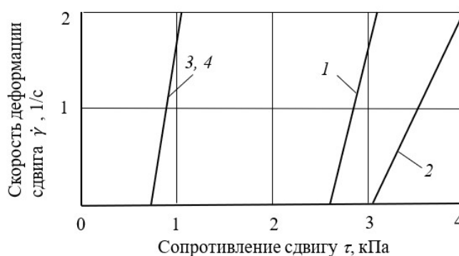
Рис. 5. Графики \dot{\gamma} = f(\tau) океанического ила при времени тиксотропного упрочнения t_{упр} = 1 и 6 сут: 1, 2 – пикового ( \tau_{max} ); 3, 4 – остаточного ( \tau_{res} ): (иллюстрация автора)
