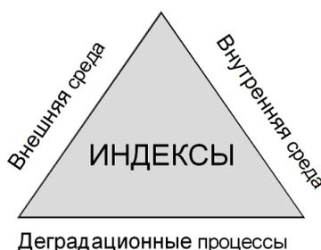
Рис. 2. Триада долговечности и индексы влияния системных факторов на деградацию и долговечность железобетона (иллюстрация авторов)
