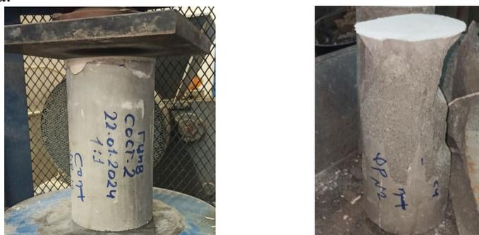
Рис.4. Характер разрушения образца-цилиндра при сжатии
