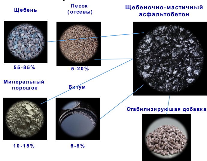
Рис. 1 – Традиционный состав щебеночно-мастичного асфальтобетона (иллюстрация авторов) Fig. 1 - Traditional composition of crushed-mastic asphalt concrete (illustration by the authors)
