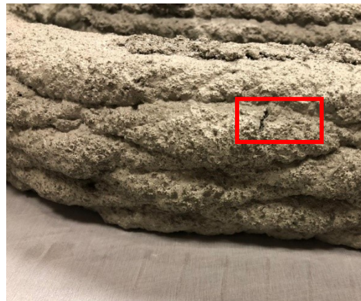
г) отклонение длины и ширины изделия от проектного значения, наплыв в стартовой точке
