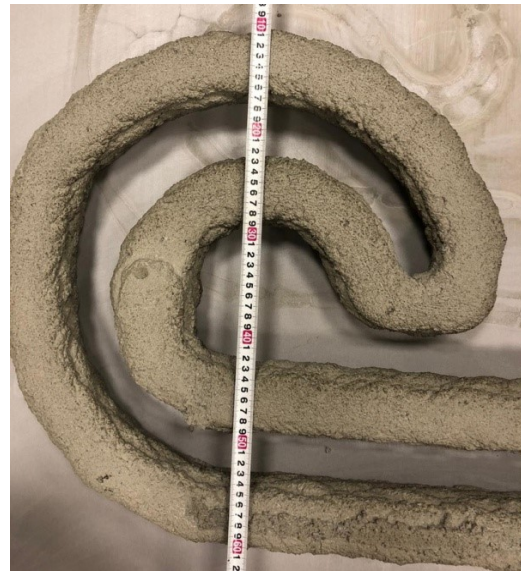
г) отклонение длины и ширины изделия от проектного значения, наплыв в стартовой точке
