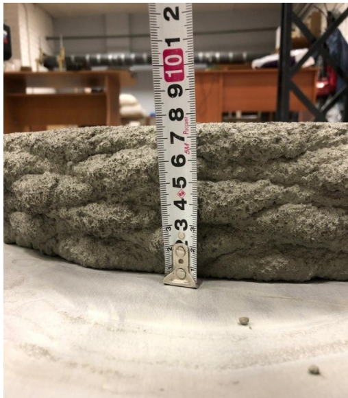
в) отклонение высоты слоев изделия от проектного значения
