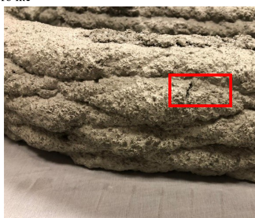
г) отклонение длины и ширины изделия от проектного значения, наплыв в стартовой точке
