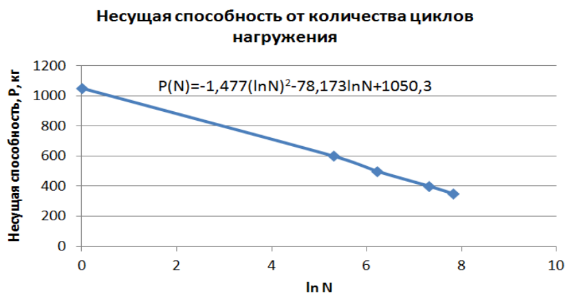
Рис.2. Изменение несущей способности моделей плитно-свайных фундаментов при циклическом нагружении (иллюстрации автора):
