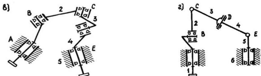
Рис. 2. Схемы пятизвенного и шестизвенного механизмов (иллюстрация авторов):
