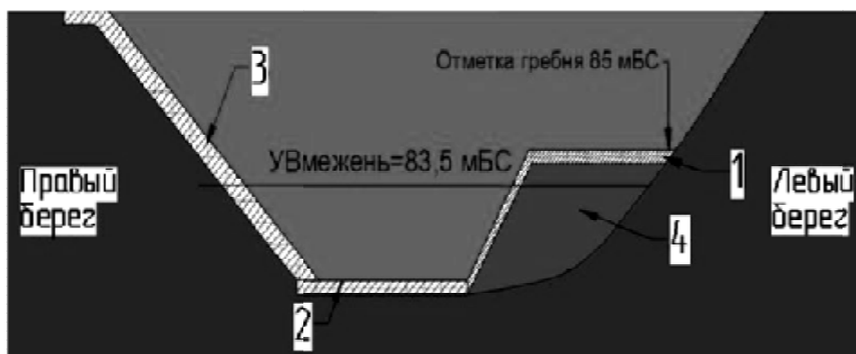
Рис. 6. Конструкция русла после сужения: 1 – крепление откоса и гребня дамбы; 2 – крепление дна русла; 3 – крепление правого берега; 4 – продольная дамба (иллюстрация авторов)
