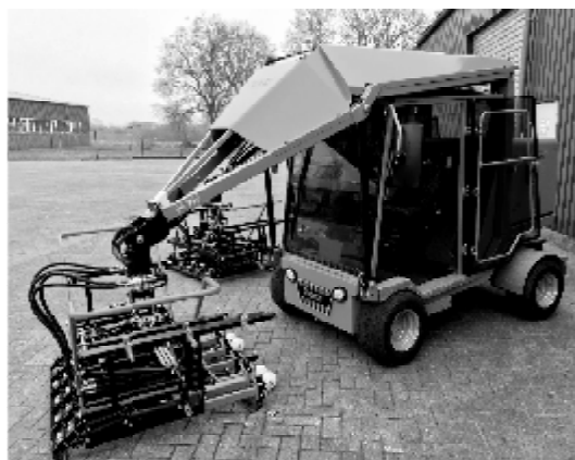
Рис. 4. Машина для укладки тротуарной плитки Optimas T11 [7]
