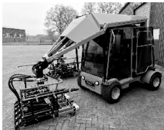
Рис. 4. Машина для укладки тротуарной плитки Optimas T11 [7]
