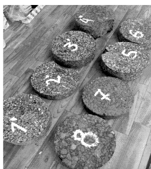
Рис. 1. Образцы кернов из асфальтобетонного покрытия (верхний слой)
