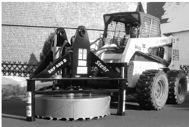
Рис. 6. Общий вид фрезы для вырезания люков Stehr SKF 950
