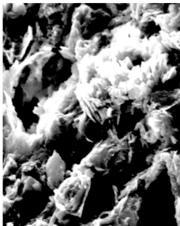
Рис. 2. Поверхность гидратированного C_3A с добавкой карбонатного микронаполнителя (10 %). Сканирующая электронная микроскопия ( \times 4500 )
