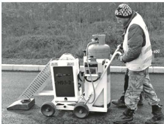
Рис. 1. Общий вид сушилки дорожного покрытия Н95-2
