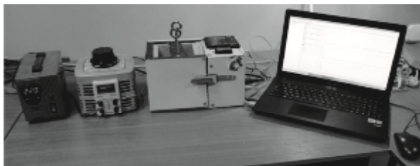
Рис. 1. Комплект используемого оборудования (слева направо: стабилизатор напряжения; лабораторный автотрансформатор ЛАТР; установка по исследованию теплопроводности тонкослойных теплоизоляторов; компьютер)
