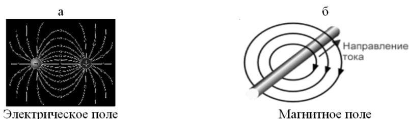
Рис. 1. Силовые линии электрического и магнитного полей
