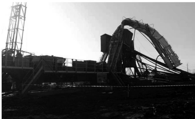
Рис. 3. Общий вид буровой установки после разрушения мачты
