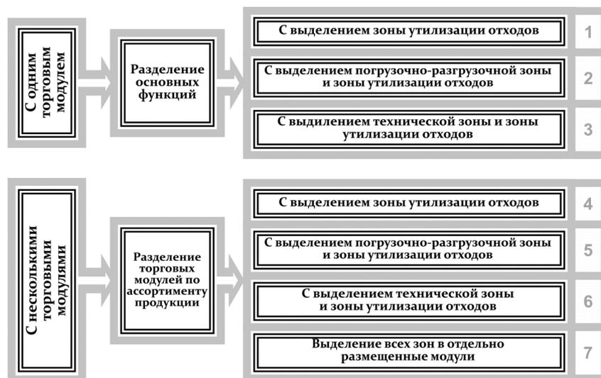
Рис. 3. Варианты планировочной организации оптовых и оптово-розничных рыночных комплексов
