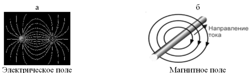
Рис. 1. Силовые линии электрического и магнитного полей
