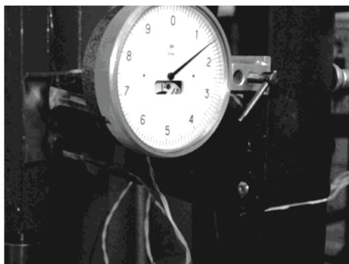
Рис. 3. Прогибомеры, установленные в испытуемой системе
