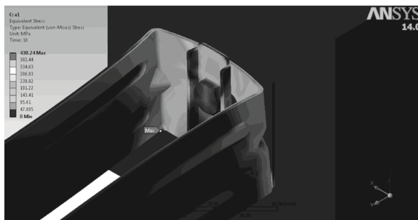
Рис. 5. Эквивалентные напряжения, возникающие в элементах ФС при использовании стандартной УШ
