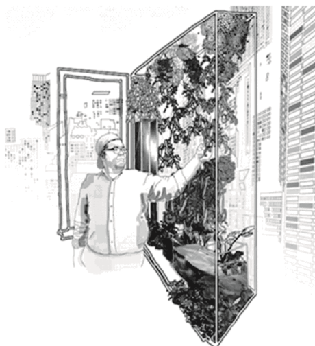
Рис. 2. Сад-аквариум с открывающимися стеклянными створками со стороны помещения
