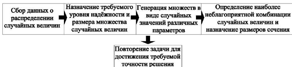
Рис. 3. Схема статистического моделирования
