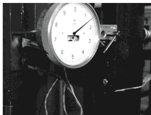
Рис. 3. Прогибомеры, установленные в испытуемой системе
