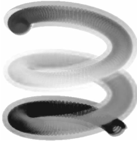
Рис. 1. Змеевиковый теплообменник
