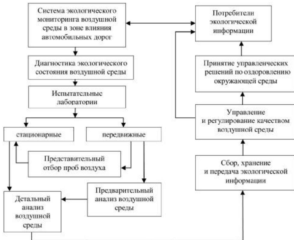
Рис. 2. Схема организации системы экологического мониторинга воздушной среды в зоне влияния автомобильных дорог и транспортных магистралей
