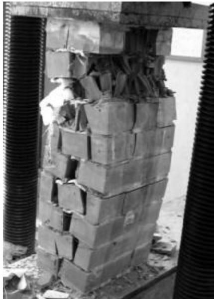
Рис. 4. Характерные особенности разрушения образцов. Наличие податливого вкладыша провоцирует концентрации напряжений на границе срез и изгибно-сдвиговые повреждения кирпичей (а, б)
