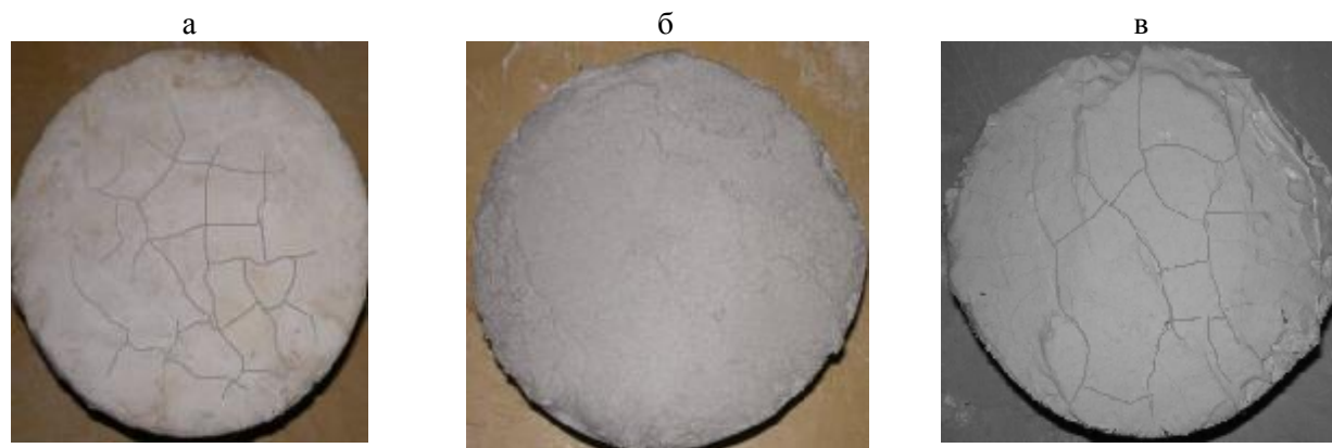
Рис. 2. Образцы, обработанные гидроизоляционными материалами проникающего типа: а – «Пенетрон», б – «Антигидрон 1», в – «Антигидрон 3»
