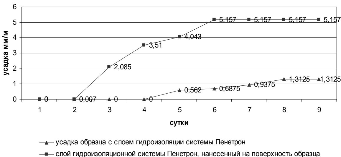
Рис. 3. Кинетика усадочных деформаций цементно-песчаного раствора, обработанного гидроизоляционным составом системы «Пенетрон», и самого гидроизоляционного слоя системы «Пенетрон»
